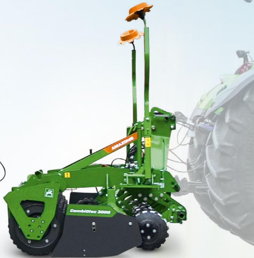
Dank des Schnellkuppelsystems QuickLink kann die Sämaschine sehr einfach, schnell und werkzeuglos mit den unterschiedlichen Bodenbearbeitungsgeräten von AMAZONE verbunden werden. Auf diese Weise lassen sich für unterschiedlichste Böden und Anforderungen optimierte Säkombinationen realisieren.
