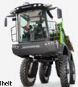
**2014:** Selbstfahrer *Pantera 4502-H* mit 1,7 m Bodenfreiheit
