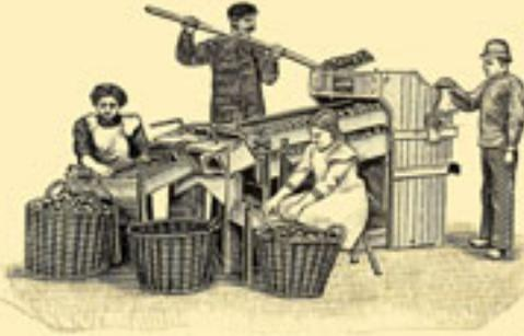
**Ausleseapparat an Patent „Federkraft“
