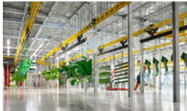
Die auf ca. 8.000 m<sup>2</sup> überdachter Grundfläche erbaute KTL-Lackieranlage ist auf eine Kapazität von 750.000 m<sup>2</sup> pro Jahr ausgelegt.
