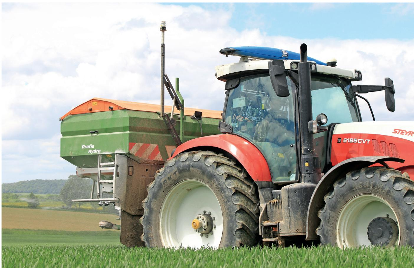
Oben auf dem ausfahrbaren Mast sitzt der Windsensor des Amazone-Düngerstreuers.
