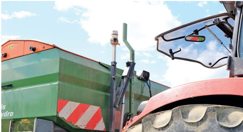
Eingeklappt in die Transportposition bleibt der Windsensor innerhalb der Fahrzeughöhe.
