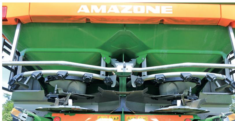
Insgesamt 14 Radarsensoren (die schwarzen Bauteile auf dem Rohrbügel) überwachen den Abwurfwinkel des Düngers.
