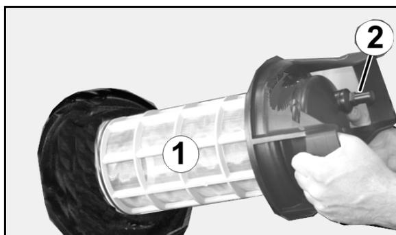
**Druckfilter bei befülltem Spritzflüssigkeitstank reinigen**
