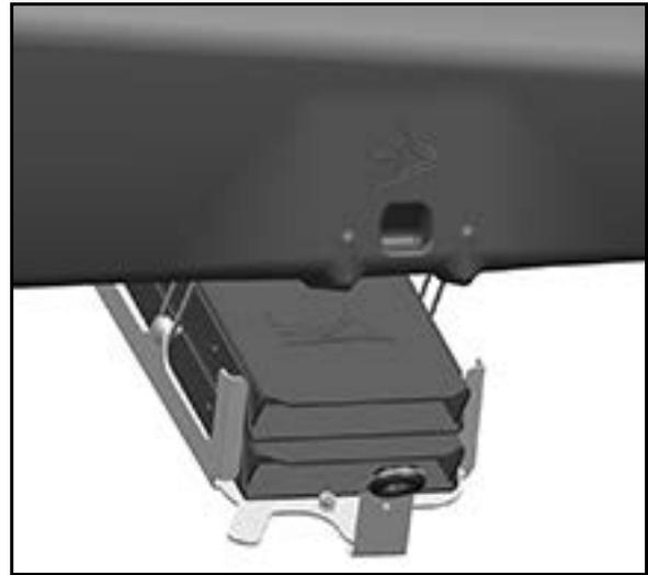
Die klappbaren Unterlegkeile durch Betätigen des Druckknopfes in Einsatzstellung bringen und vor dem Abkuppeln direkt an die Räder anlegen.
