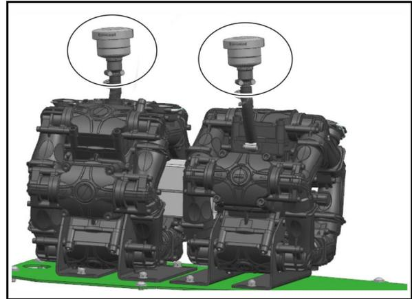
1. Kontrollieren, ob der Ölstand an der Markierung bei nicht laufender und waagrecht stehender Pumpe sichtbar ist.
