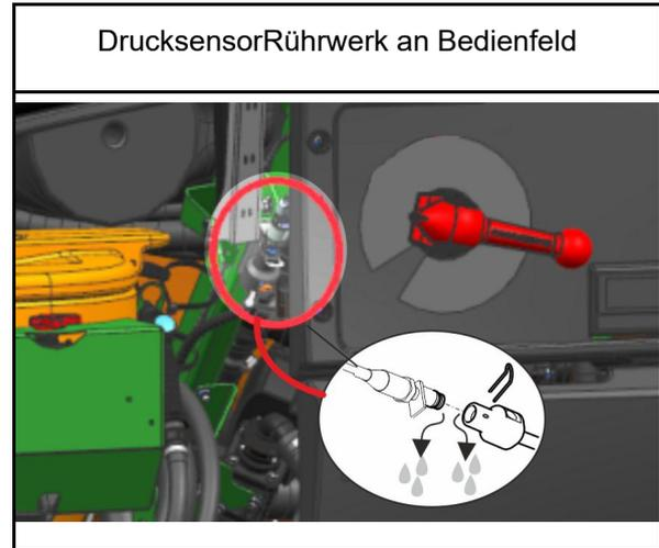
24. Verbliebenes Restwasser im Ablauf der Leitungfilter mit Ablasshahn ablassen.
