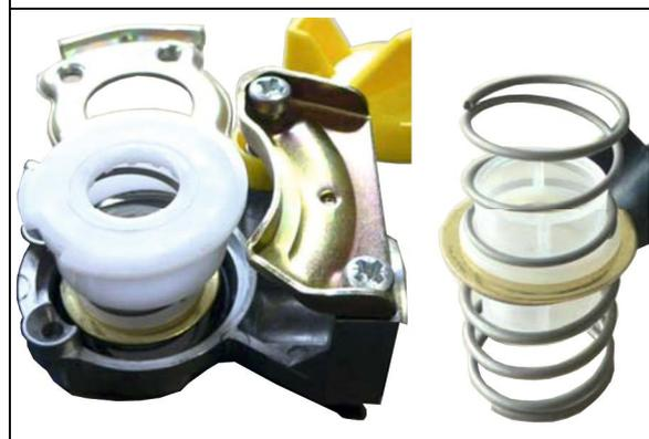
**!** O-Ring korrekt auf dem Kunststoffring positionieren.
