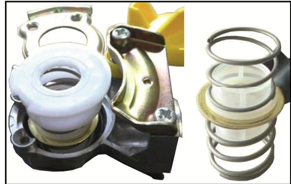
**!** O リングを正しくプラスチックリングに位置決めします。
