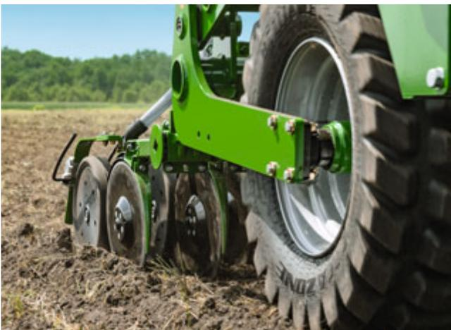
Über Applikationskarten kann der Schardruck innerhalb einer Fläche variiert werden.
