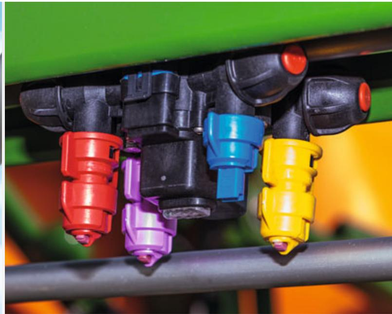
AmaSelect mit 4-fach-Düsenkörper mit LED-Einzeldüsenbeleuchtung
