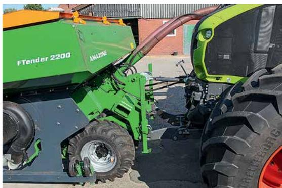
Шинный прикатывающий каток прикручивается непосредственно к бункеру. Его, кстати, при случае можно использовать и как отдельное орудие...
