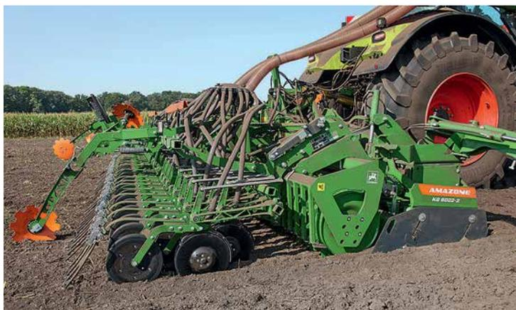
*При наличии гидравлической регулировки опорной нагрузки на сошники бонусом идет механизм выглубления сошников бруса на 15 см — скажем, для предварительной обработки ротационным культиватором*
