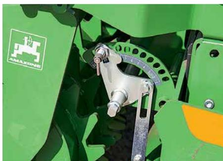
*Новинкой на культиваторе стала удобная регулировка отражающего щита...*
