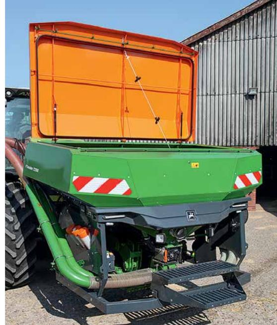
К дозатору и бункеру *FTender 2200*, в данном случае работающему под давлением, есть удобный доступ
