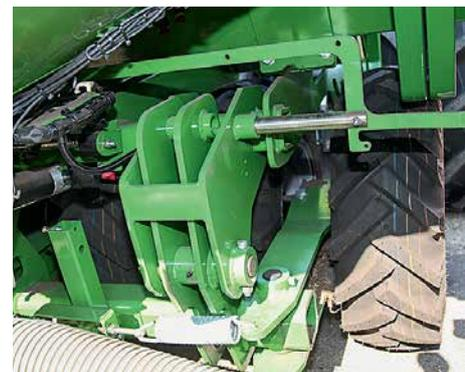
...а еще для транспортировки его можно приподнять и заблокировать, а бункер, соответственно, приспустить
