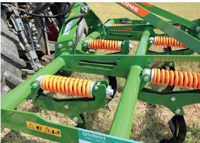
Auf den runden Rohren bleibt keine Erde liegen, auf beiden Seiten des Anbaubocks leider schon (was zudem die gute Wasserwaage verdeckt).
