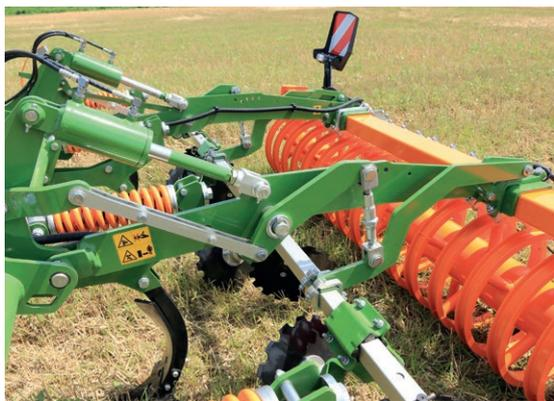
Wird die Arbeitstiefe hydraulisch über die Walze verstellt, passt sich über ein Hebelsystem automatisch auch die Einstellung der Scheiben an.
