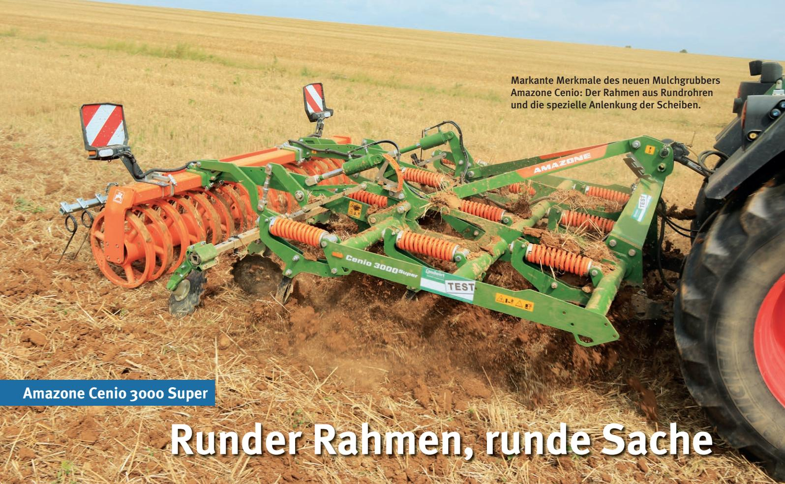
Markante Merkmale des neuen Mulchgrubbers Amazone Cenio: Der Rahmen aus Rundrohren und die spezielle Anlenkung der Scheiben.
