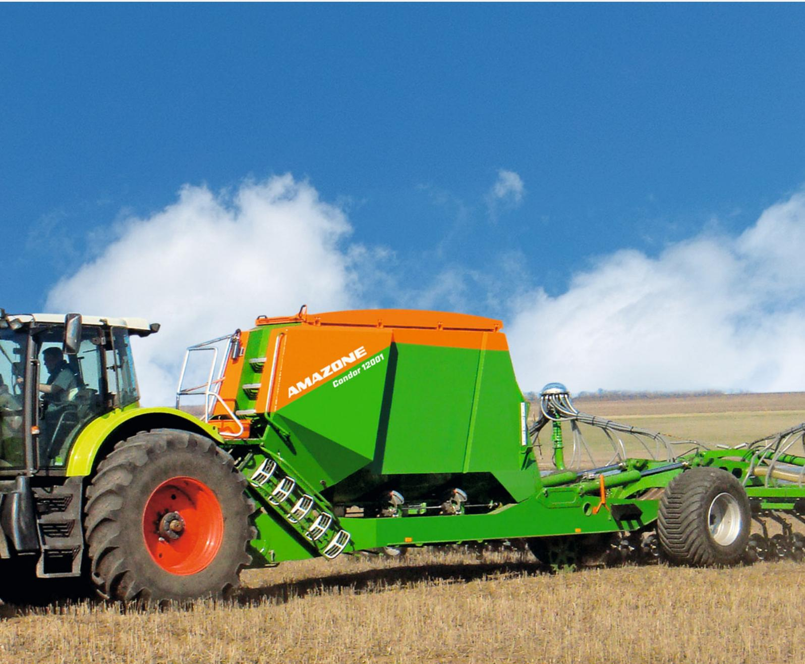
Le semoir traîné Condor travaille avec les dents de semis ConTeC pro guidées individuellement et des inter-rangs de 25 cm et 31,3 cm/33,3 cm, permettant des conduites de culture particulièrement extensives dans les régions continentales sèches. Avec ses largeurs de travail de 12 m et 15 m et sa trémie sous pression à 3 compartiments d'une capacité de 7 800 l, le Condor offre un important débit de chantier.
