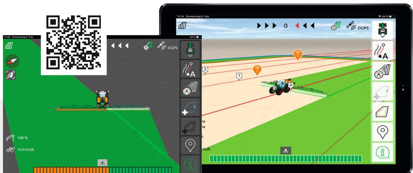
Mode d'affichage Cartes avec AmaTron Twin – Représentation claire de la machine et de ses tronçons ; boutons de commande à droite de l'écran de la tablette
