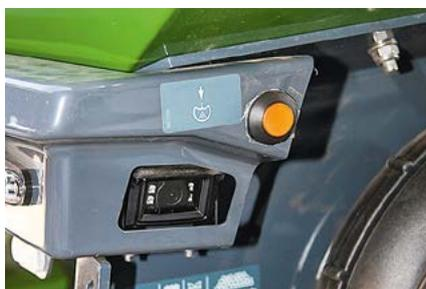
*Unter dem Abdrehtaster ist auf der linken Seite einer der beiden Seitenkameras positioniert.*
