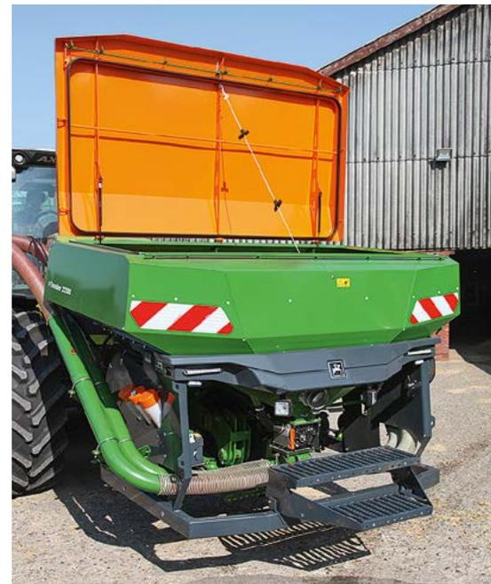
*Dosierung und Behälter des FTender 2200 – hier als Drucktank – sind gut zugänglich.*
