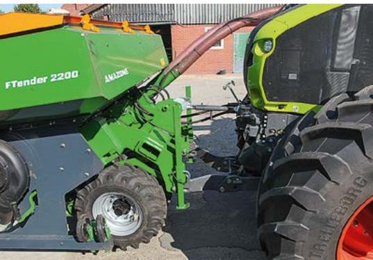
Der Reifenpacker ist mit dem Fronttank verschraubt. Er kann solo eingesetzt...
