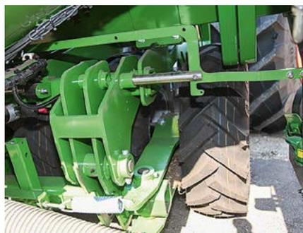
...und für die Straßenfahrt mit abgesenktem Tank in oberer Position arretiert werden.
