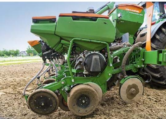
Die Saatgutbehälter fassen jetzt 70 l. Hier das Aggregat mit fix einstellbarem Düngerschar.
