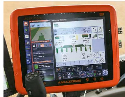
Die Maschine ist ISO-Bus-kompatibel und lässt sich über verschiedene Terminals bedienen.
