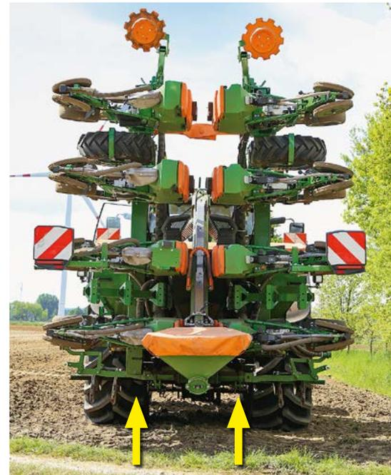
Neben der Befüllschnecke sind die unterschiedlich langen Rahmensegmente zu erkennen.
