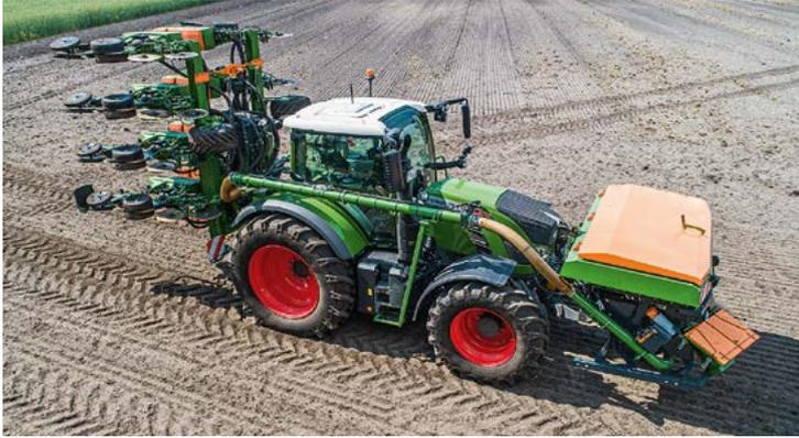
*Der 6 m breite Rahmen kann auch ohne Düngerkomponenten oder mit einem Fronttank-System eingesetzt werden.*
