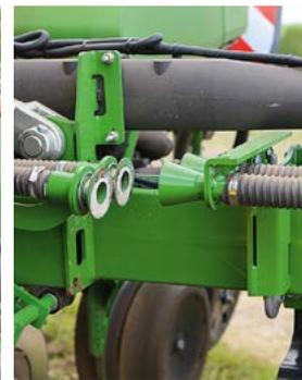
Die äußeren Düngerschläuche werden beim Klappvorgang automatisch gekoppelt oder getrennt.
