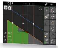
Граница поля, виртуальная разворотная полоса, оптическая система параллельного вождения и посекционное включение
