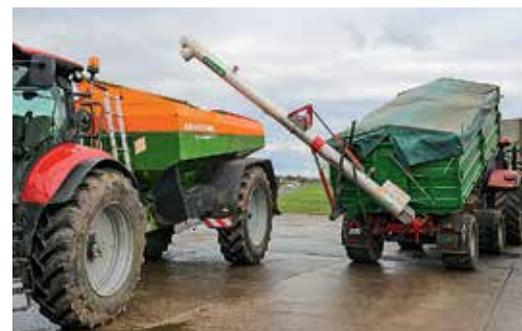
Удобрения загружаются на краю поля с помощью прицепа, укомплектованного перегружающим шнеком
