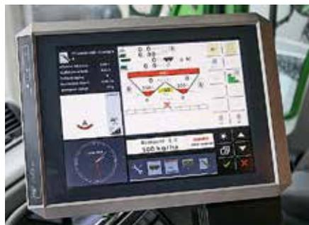
Терминал производства компании Müller-Elektronik обеспечивает возможность управления разбрасывателем из кабины грузовика-вездехода *Unimog*
