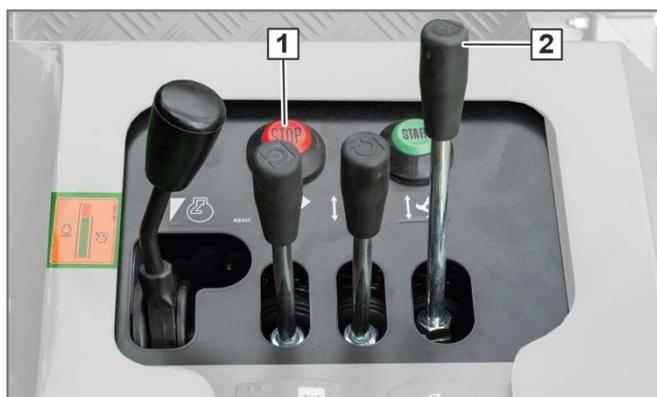
1. Desconectar el accionamiento del mecanismo de segado con el interruptor de parada (1).
