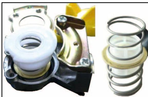
**!** Positionner correctement le joint torique sur la bague en plastique.
