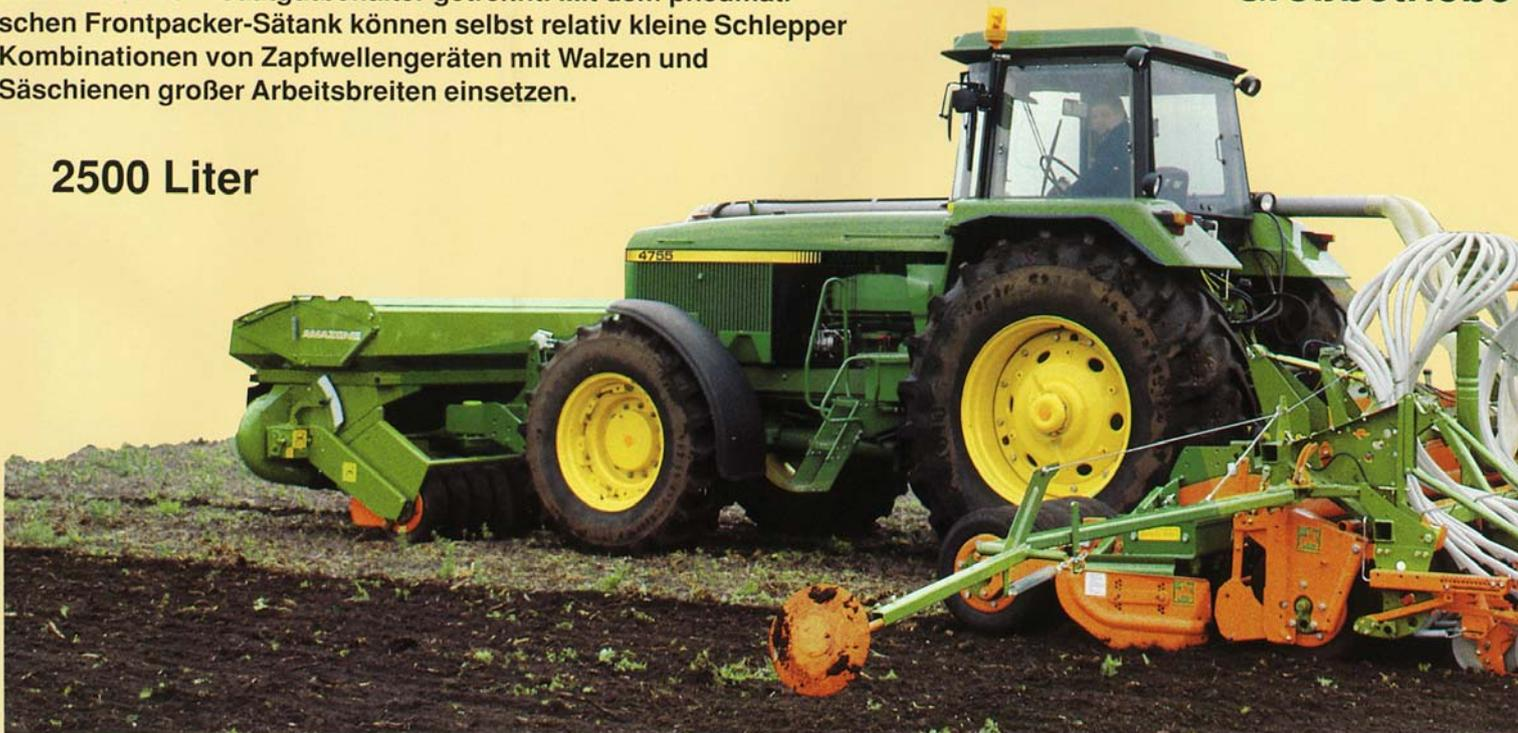
Pneumatischer Frontpacker-Sätank und 6 m-Kreiselgrubber mit Reifenpacker-Sämaschine
