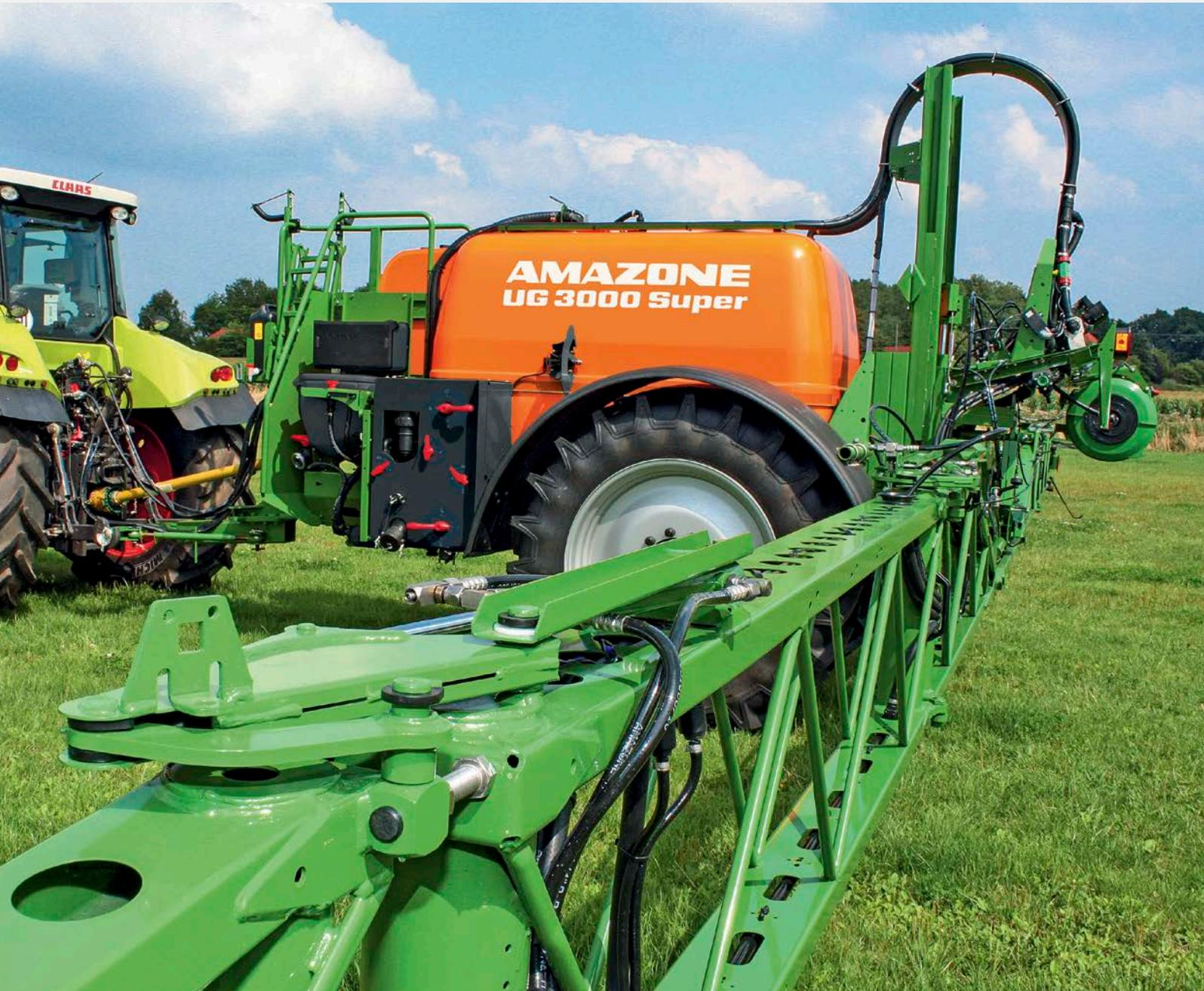
Si el terminal a manejar está equipado con la función Section Control, como p. ej. en el caso del control de anchos parciales GPS Switch de AMAZONE, los anchos parciales se pueden conmutar de forma completamente automática y en función de la posición GPS. Si se ha trazado una parcela, el operador puede concentrarse por completo en el manejo del vehículo en modo automático, ya que la conmutación de los anchos parciales tiene lugar de forma automática en las cuñas y en los bordes de la parcela.
