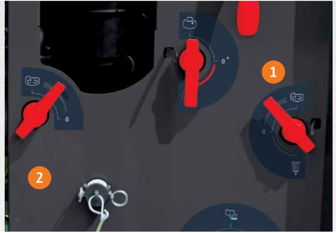
En las pulverizadoras para cultivos de AMAZONE, la corriente de enjuague del filtro de presión (el cual se lava automáticamente) se utiliza para agitar (conmutación mediante pos. 1). Para lograr potencias de agitación elevadas con pocas revoluciones del árbol de toma de fuerza, se recomienda el equipamiento con bomba de UG Super (conmutación mediante pos. 2).
