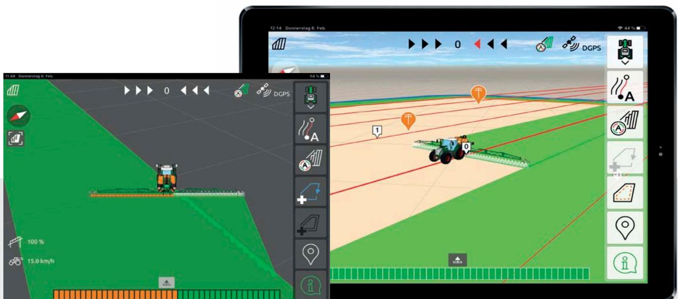
Vista de mapas con AmaTron Twin: representación clara de la máquina de trabajo y sus anchos parciales, así como botones en el lado derecho de la pantalla de la tableta
