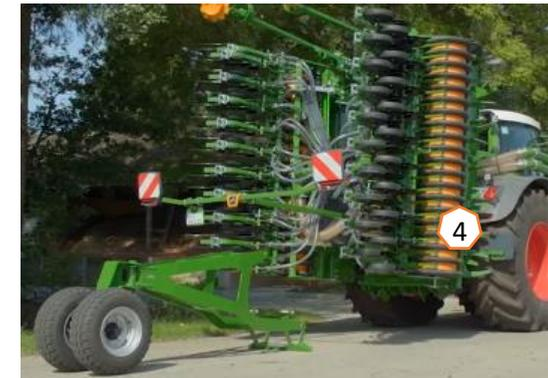
**Hinweis:** Die Option Transportfahrwerk beinhaltet einen hydraulischen Oberlenker mit elektrischer Schwimmstellung. Diese muss bei Straßenfahrt aktiviert (5) und das entsprechende Traktorsteuergerät in Schwimmstellung geschaltet werden.
