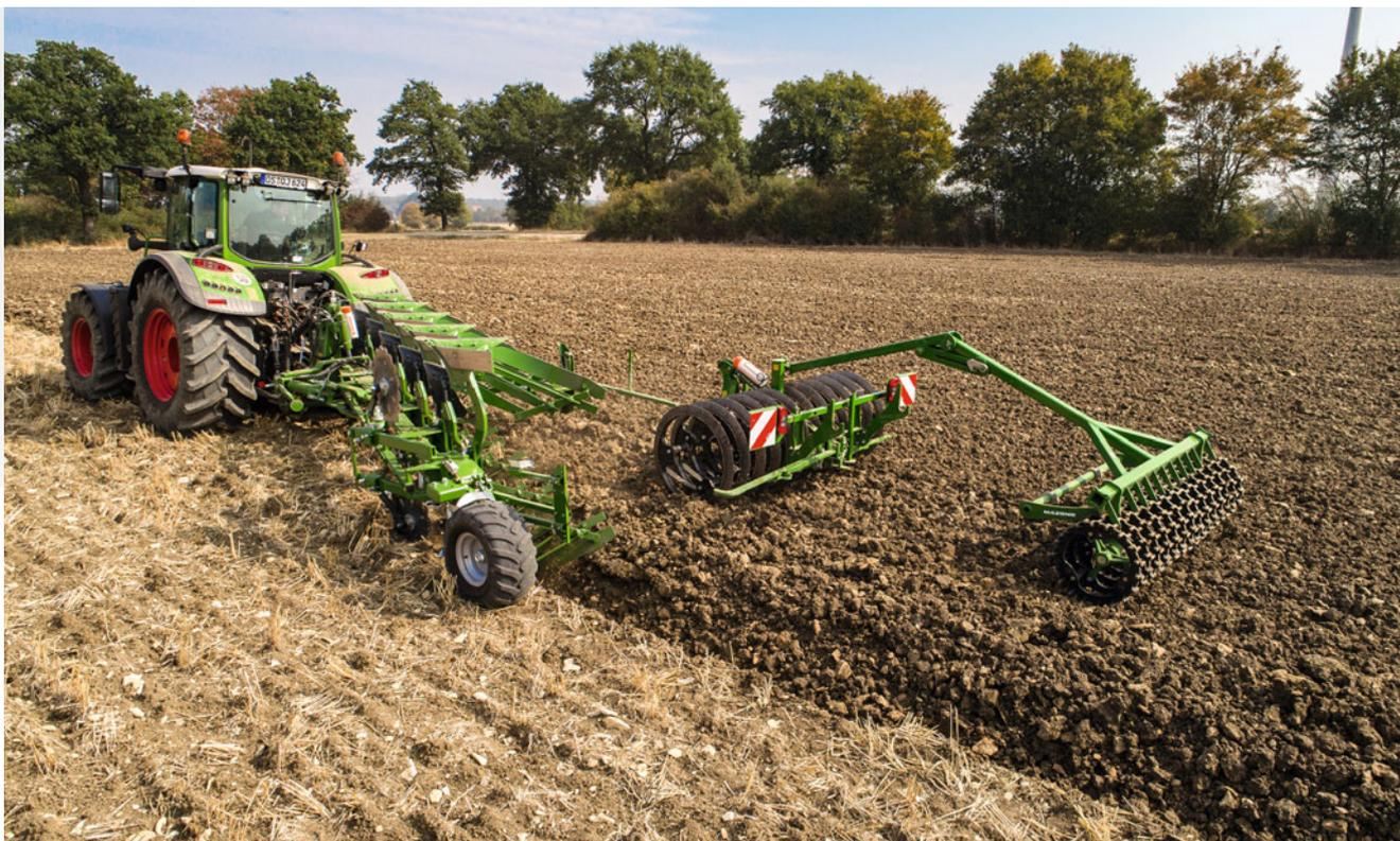
Para el uso combinado con compactadoras de volteo, todos los arados Cayros pueden equiparse con un brazo compactador con desbloqueo hidráulico. Gracias a un acoplamiento directo con el sistema hidráulico de giro del arado suspendido, no se necesita ningún controlador adicional.
