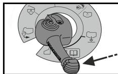
4. Spurgare il filtro a pressione tramite il rubinetto d'intercettazione **DE**.
