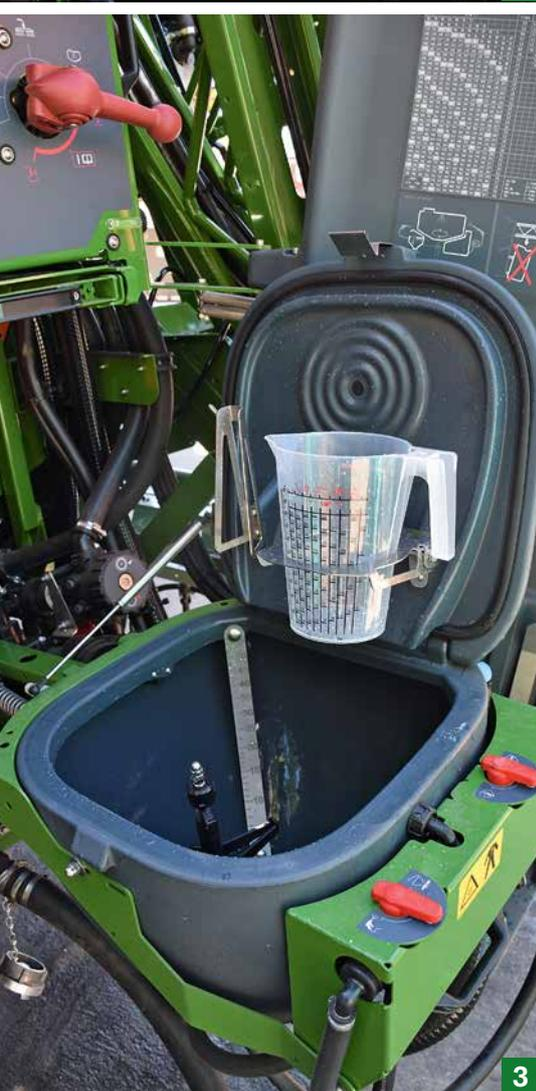
den die Präparate beim Einspülen nicht zu stark aufzuschäumen, lässt sich die Mischdüse auch ausschalten. Die Einspülschleuse reinigt man nach dem Einfüllen, indem man den geschlossenen Deckel auf die Kanisterspüleinrichtung drückt. Im Gegensatz zur Vorgängerbauweise erkennt man hier aber genau, wo man drücken muss. Außerdem geht das durch den weichen Kunststoff an dieser Stelle nun wesentlich einfacher.
