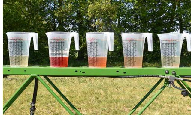
△ Wie die kontinuierliche Innenreinigung arbeitet, haben wir mit Rote-Beete-Saft simuliert. Links vor dem Einfüllen, rechts danach.
