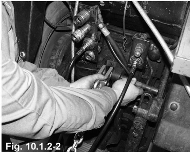
Si se ha colocado la máquina ya ajustada sobre una base plana, se deberá pretensar el sistema mecánico de resorte un poco hasta la mitad del agujero oblongo (fig. 10.1.2-3). Si no es así, habrá que corregir la longitud activa de la cadena en el brazo superior de resorte. Esta comprobación debería realizarse en cualquier caso si se modifica el ajuste de altura de las ruedas guía delanteras o el rodillo de apoyo.
