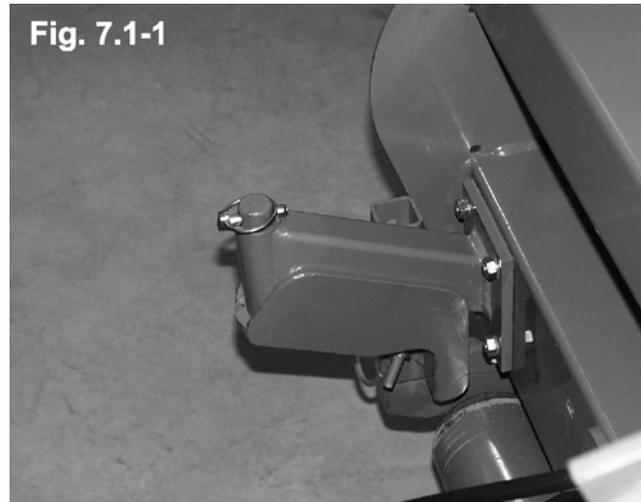
Para ajustar la altura, se debe retirar el pasador y el perno de ambos lados y colocar el rodillo en la posición deseada (fig. 7.1-2).
