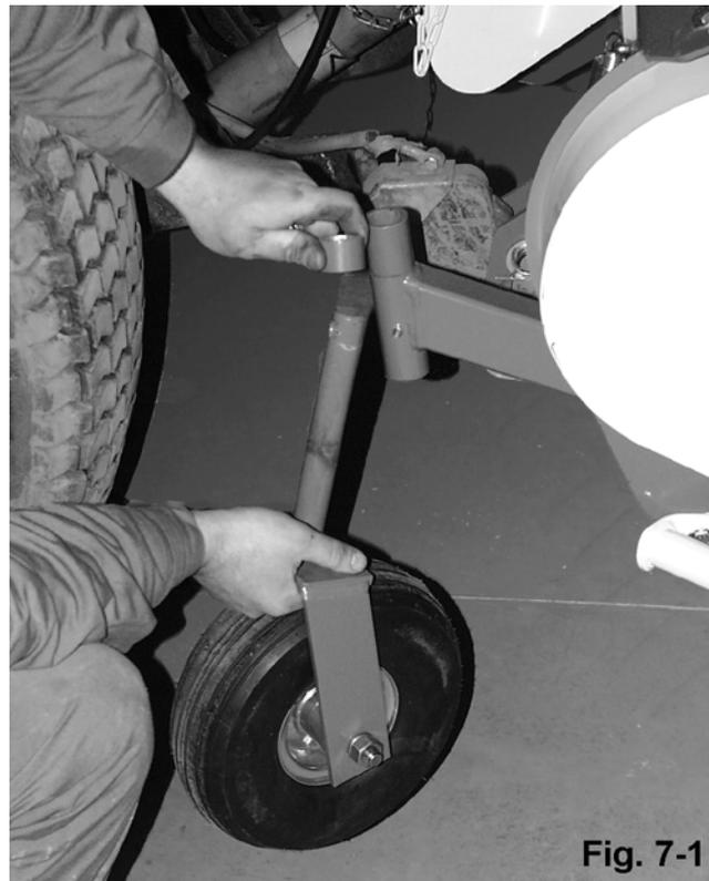
El ajuste de la altura del rodillo de apoyo trasero se realiza del siguiente modo.
