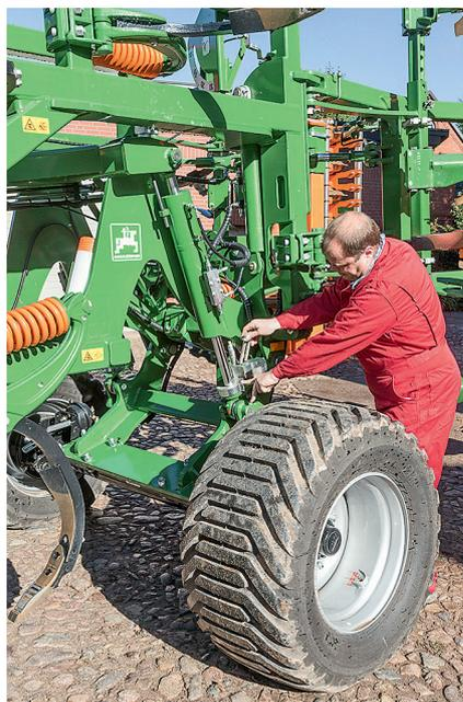
*Wer ohne Walze arbeiten möchte, justiert die Arbeitstiefe über einschwenkbare Anschläge am Fahrwerk.*
