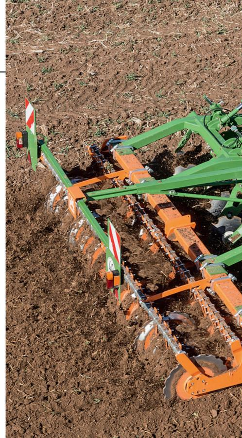
**D**ie Scheibeneggen-Grubber-Kombination Ceus 4000-2TX ist eine interessante Maschine und soll sämtliche Bereiche der passiven Bodenbearbeitung abdecken. Normalerweise erledigt der Ceus vorne eine flache Stoppelbearbeitung und hinten eine tiefere, mischende Bodenbearbeitung. Wahlweise kann aber auch nur vorne oder nur hinten gearbeitet werden.
