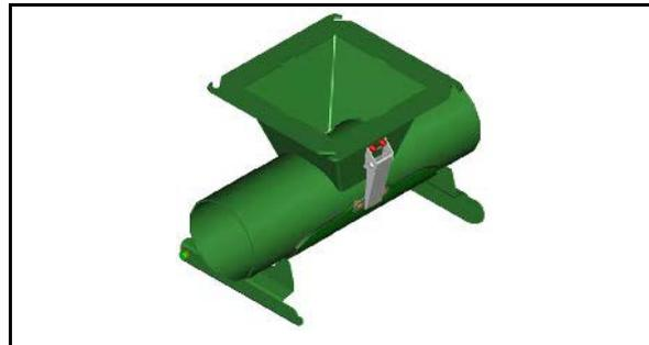
Doppelschleuse mit Einstellklappe und Einstellhebel an Doppelförderstrecke
