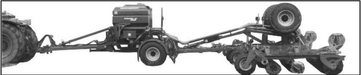
Der XTender wird über die Verbindungseinrichtung der Deichsel an den Traktor gekuppelt.
