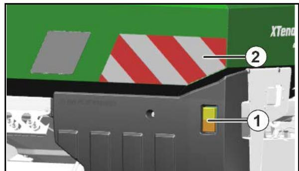
Schließen Sie die Beleuchtungsanlage über den Stecker an die 7-polige Traktor-Steckdose an.
