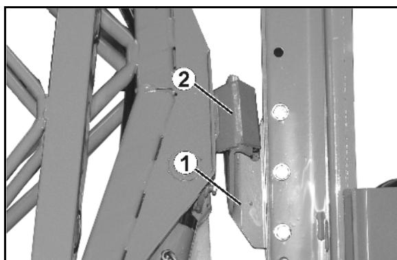
Compruebe el bloqueo del varillaje Super S mediante el control visual.
