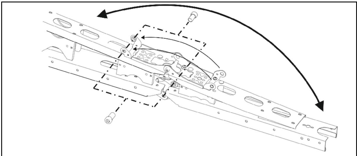
2 tornillos aseguran el elemento replegado y desplegado, más externo en sus posiciones finales correspondientes.
