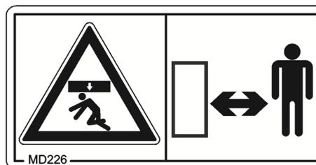
**Peligro de inestabilidad del pulverizador montado desacoplado, debido a un desacoplamiento incorrecto.**
