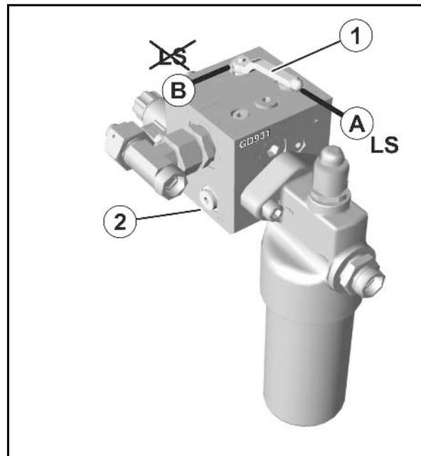
Conexiones del lado de la máquina conforme a ISO15657:
