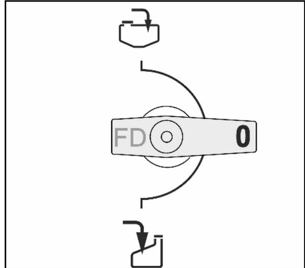
**Llave de bloqueo Vaciar tanque de líquido de rociado**
