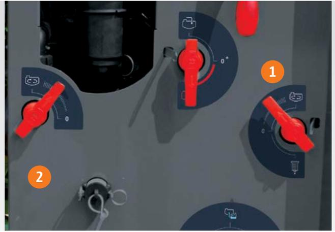
Nos pulverizadores AMAZONE, o fluxo de enxaguamento do filtro de pressão autodepurador é utilizado para agitar (ligação através da Pos. 1). Para elevadas potências de agitação com baixas rotações do veio de tomada de força, recomenda-se o equipamento de bombagem da UG Super (ligação através da Pos. 2).
