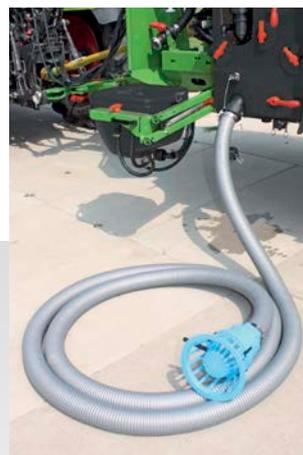
Enchimento através do tubo flexível de sucção
