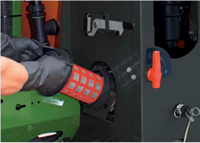
Graças ao fecho de baioneta simples da AMAZONE, o filtro de sucção deixa-se abrir de forma fácil e sem perdas de líquido de pulverização.
