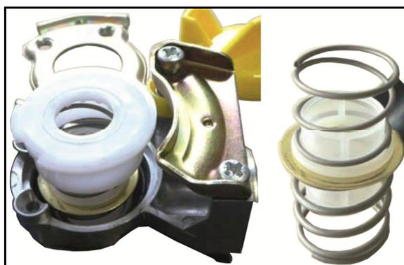
**!** Colocar la junta tórica correctamente en el anillo de plástico.
