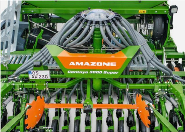
Centaya Super con cabezal distribuidor de segmentos
