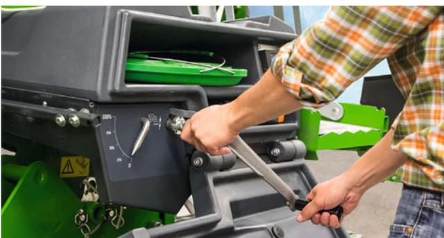
Ajuste centralizado de la profundidad de colocación
