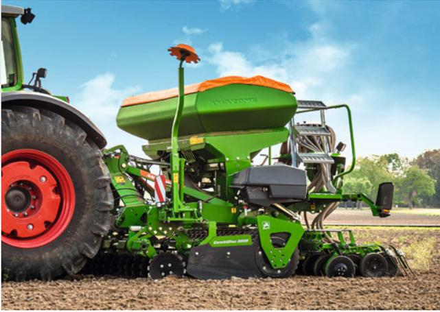
Sembradora suspendida Centaya 3000 Super con la grada de discos compacta acoplada CombiDisc 3000
