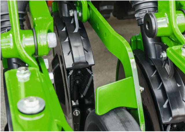
Rascador para el rodillo de guiado en profundidad (equipamiento especial)
