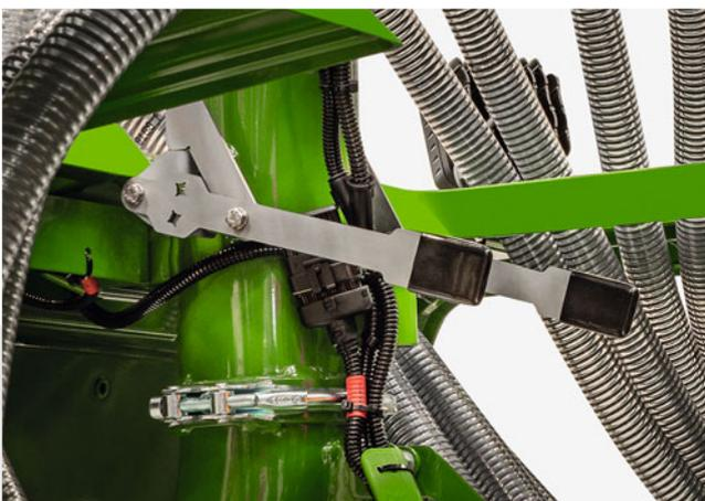
Conexión mecánica de medio lado (desactivada)
