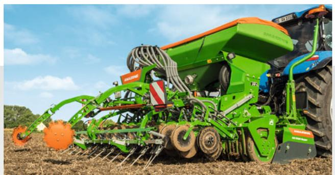
Elevación hidráulica de los discos (equipamiento especial)
