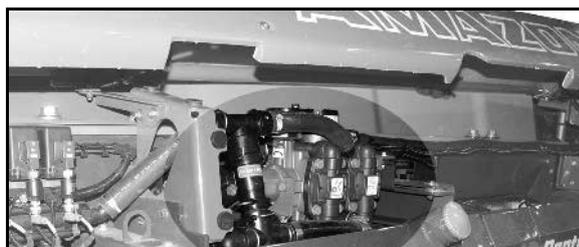
Las bombas de pulverización se activan y desactivan a través del AMADRIVE o a través de la tecla en el panel de control.
