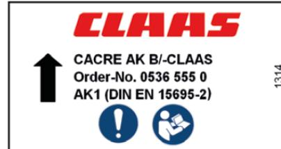
La dirección de la flecha marca la dirección de flujo. ¡Solo funcionará correctamente si se cumple la secuencia correcta!
