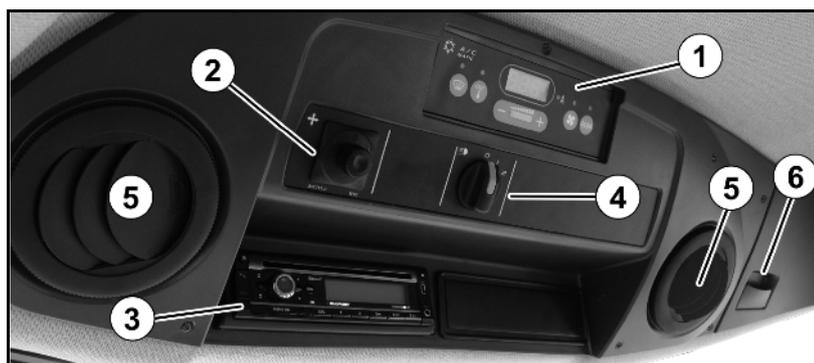
En el techo interior se encuentra el interruptor para el ventilador, la calefacción, el aire acondicionado, las luces de conducción, el ajuste del espejo y la radio.
