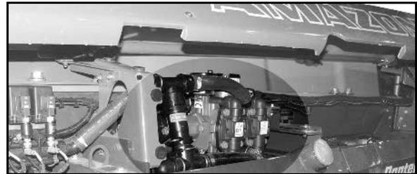
Les pompes de pulvérisation sont mises en marche et arrêtées à travers l'AMADRIVE ou par le bouton situé sur le tableau de commande.
