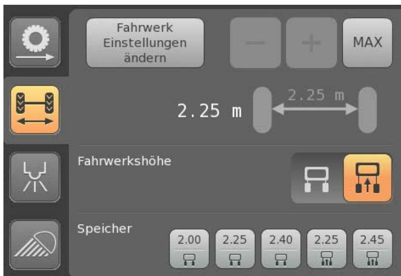
**i** Le réglage de la hauteur s'effectue en même temps que le réglage de la largeur de voie pendant un court trajet de réglage.
