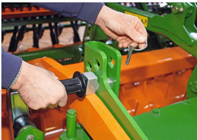
✔ Ajuste mecânico da profundidade
