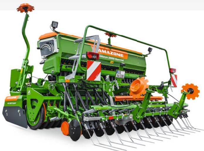
Cataya 3000 Special com 3 m de largura de trabalho, relha monodisco RoTeC-Control com raspadeira exata e capacidade de depósito de 650 l
