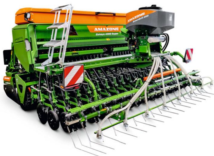
Cataya 4000 Super com 4 m de largura de trabalho, relha de disco duplo TwinTeC com raspadeira exata e capacidade de depósito de 1730 l
