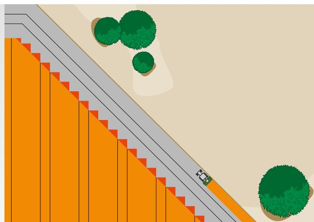
Ativação e desativação automática do doseador elétrico em função da posição com GPS-Switch
