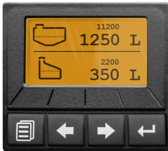
Mediante el TwinTerminal se puede conmutar la valvulería de aspiración:
