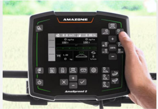
Alle Funktionen sind während des Streuvorgangs intuitiv mit einer Hand zu erreichen. Jeder Button steht für eine Funktion
