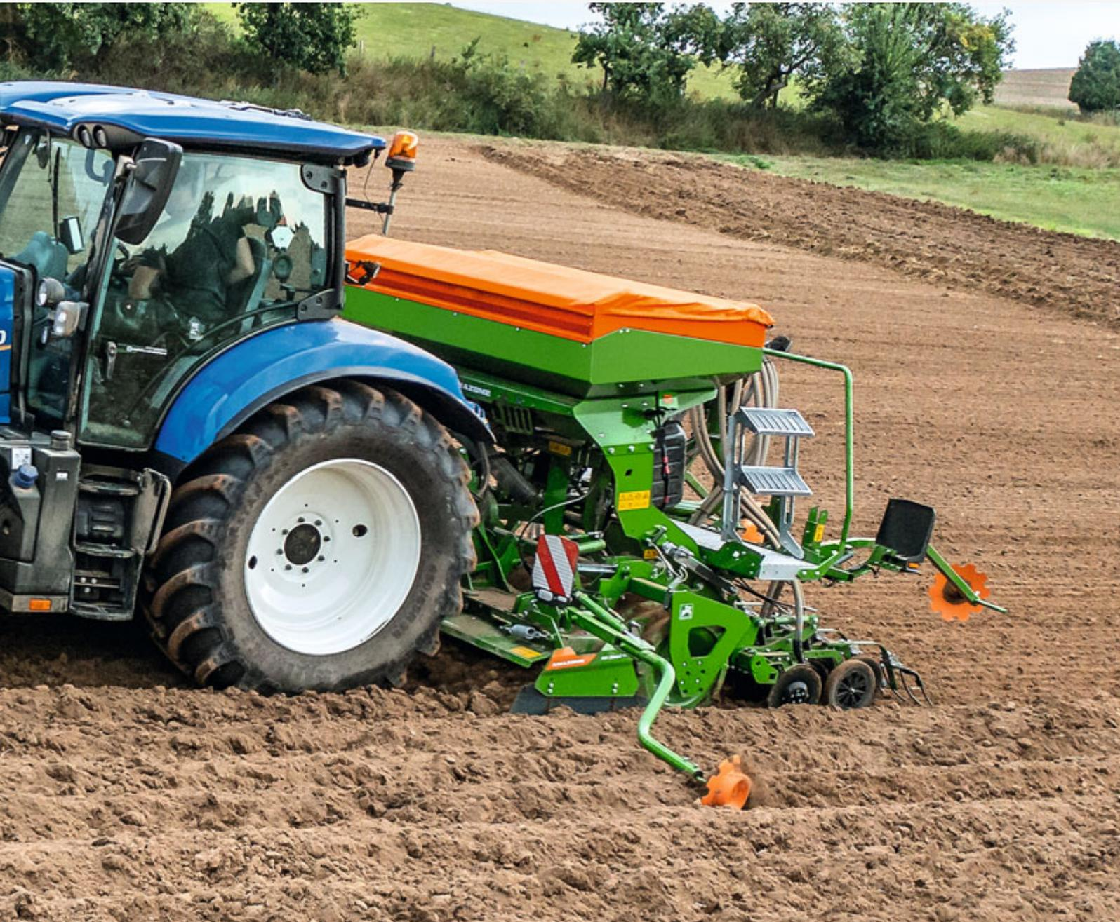
Kreiselegge KE 3002-190 Rotamix mit Aufbausämaschine Centaya 3000 Special
