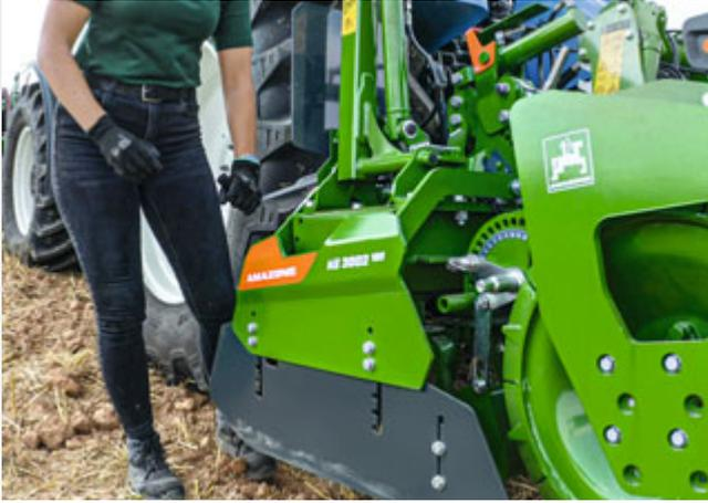
Das Seitenleitblech lässt sich mit Hilfe des universellen Bedienwerkzeugs für die Feldarbeit ausstellen
