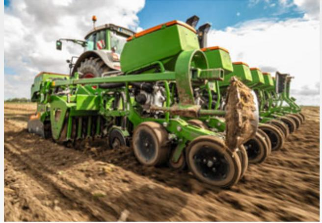
Precea Vereinzlungsaggregate, aufgebaut auf den KG 6002-2 Super, sorgen für exakte Ablage des Saatguts.
