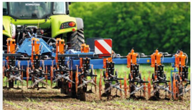
Die hydraulische Parallelogrammeinzelaushebung ermöglicht Hacken bis in die letzte Spitze sowie den größten auf dem Markt verfügbaren Hub.
