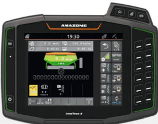
AmaTron 4 mit ISOBUS-Software für die Avant
