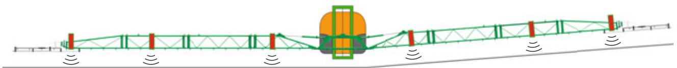
Einseitiges Anwinkeln rechts (Flex-Klappung)
