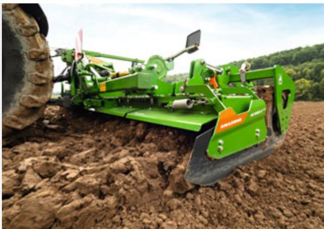
Die Werkzeugträger mit den auf Schlepp stehenden Zinken der KE 02-2 Rotamix erzeugen eine sehr gute Krümelstruktur
