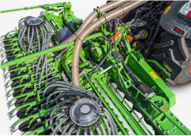
Doppelte Förderstrecke mit zwei Verteilerköpfen bei der Avant 6002-2
