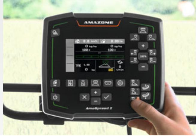
Per Tastendruck kann bequem auf die verschiedenen Grenzsituation Rand-, Grenz- und Grabenstreuen reagiert werden. Das aktuelle Streuverfahren wird dauerhaft übersichtlich im Bedienterminal dargestellt
