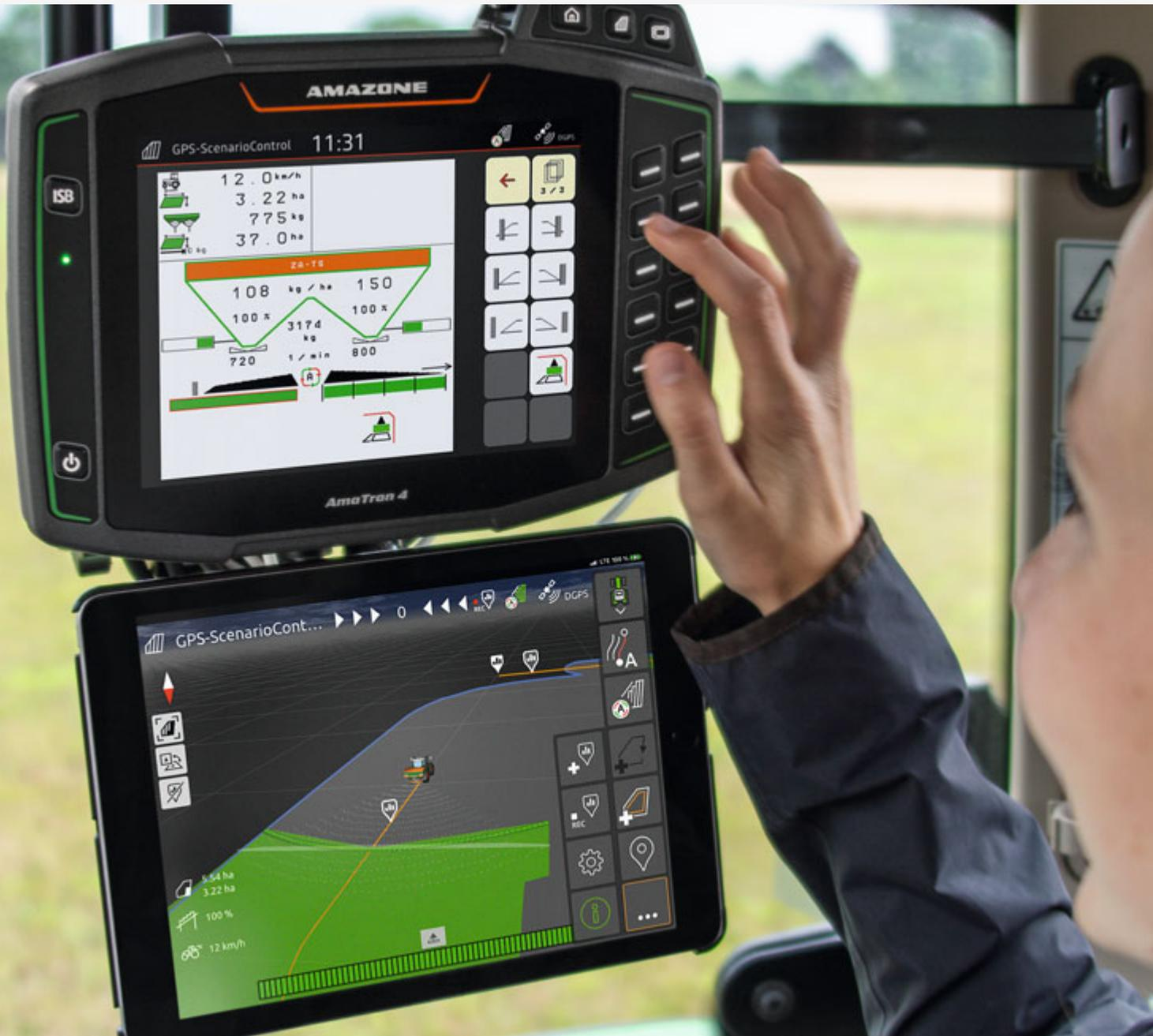
GPS-ScenarioControl kann in Verbindung mit dem ISOBUS-Bedienterminal AmaTron 4 und der App AmaTron Twin genutzt werden.
