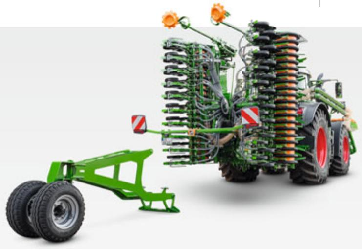
Ankoppeln des Transport-Fahrgestells im Ein-Mann-Betrieb
