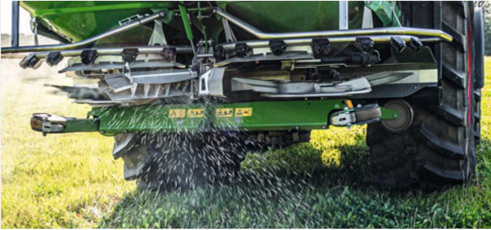
Im aktivierten Zustand wird beim ZA-TS der BorderTS-Schirm von oben in den Streufächer eingeschwenkt. Durch die besondere Lamellenstruktur und das stufenlos einstellbare Leitblech werden die Granulate schonend zu Boden geleitet.
