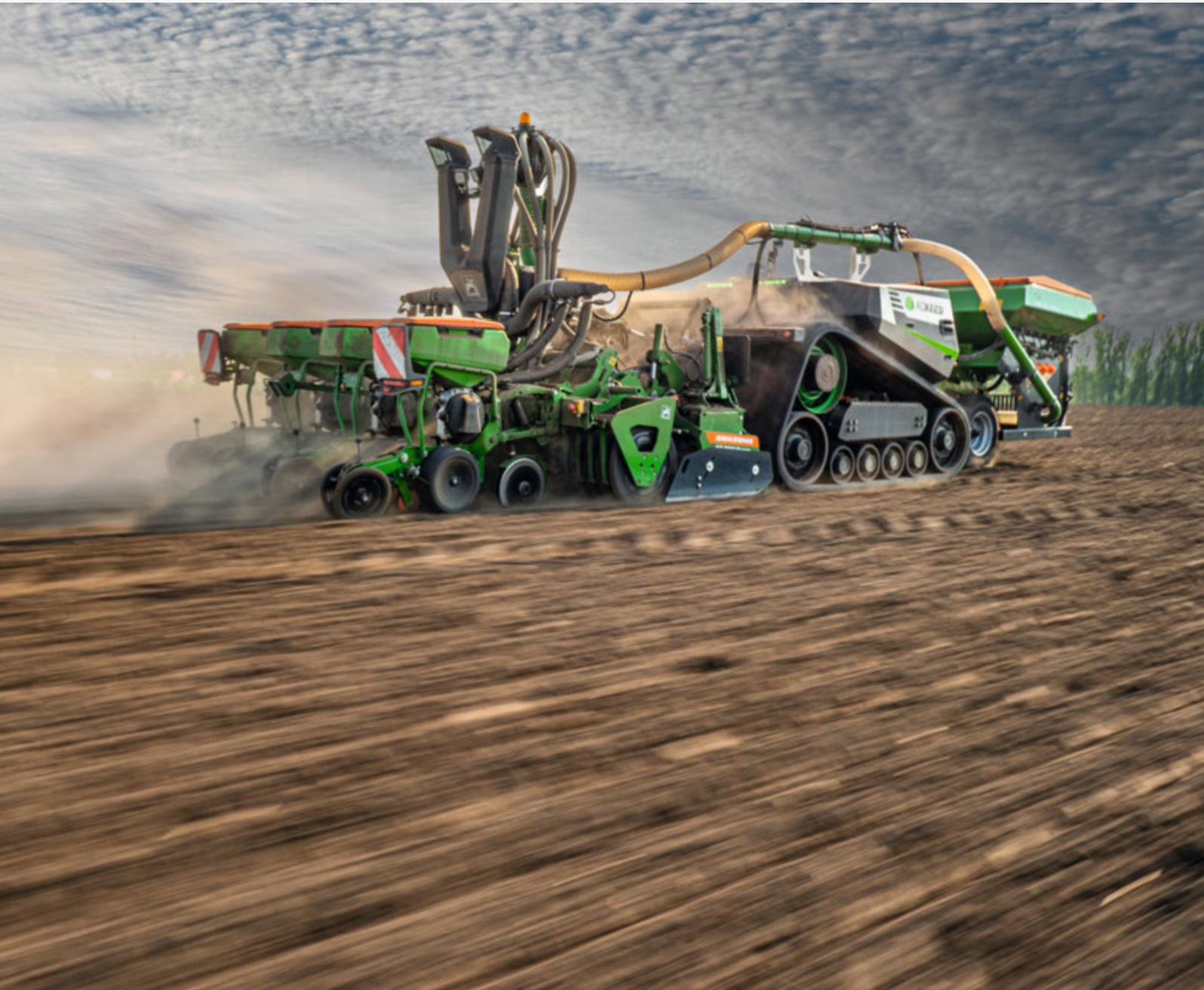
AgXeed AgBot mit Raupenfahwerk und AMAZONE Einzelkorn-Sämaschine
