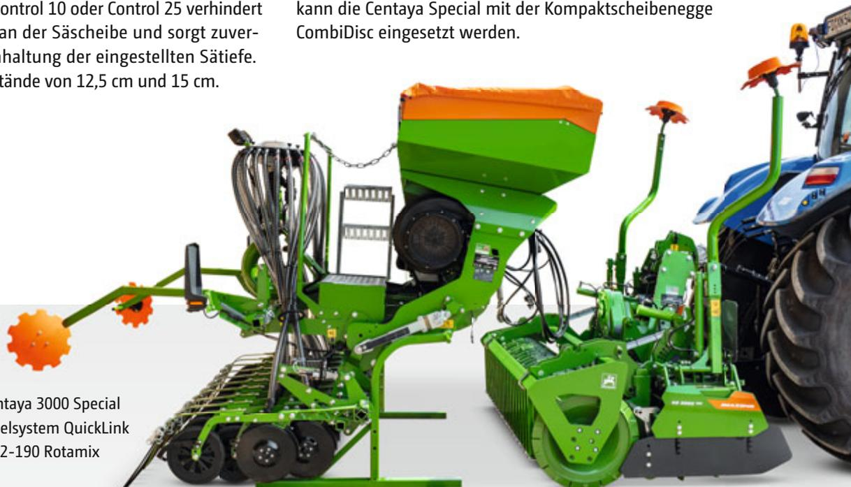
Die Aufbausämaschine Centaya 3000 Special wird über das Schnellkuppelsystem QuickLink mit der Kreiselegge KE 3002-190 Rotamix verbunden
