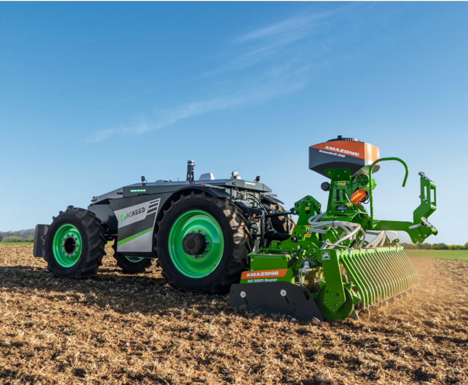
4-Rad AgXeed AgBot und AMAZONE Kreiselegge KE 3001 Super mit Aufbausämaschine GreenDrill
