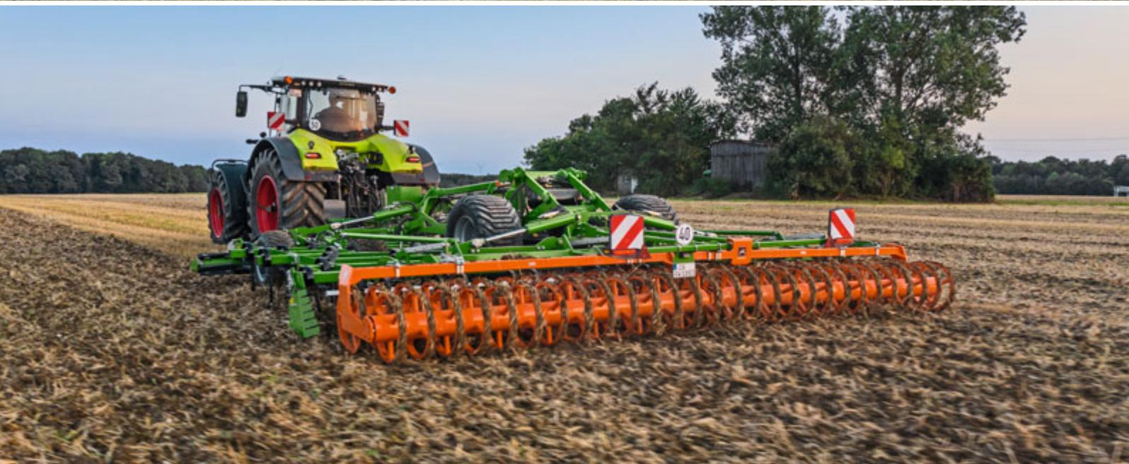
Anhängeflachgrubber Cobra-2TX in der flachen Stoppelbearbeitung
