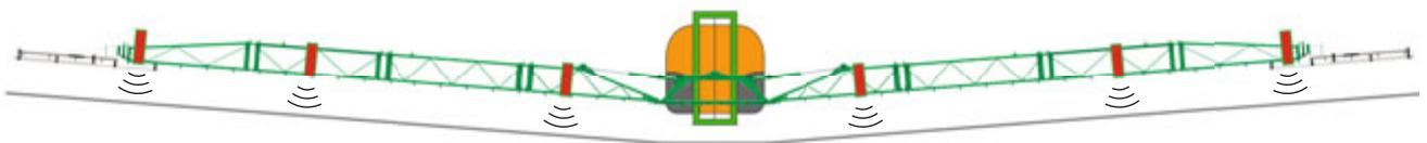
Beidseitiges Anwinkeln (Flex-Klappung)
