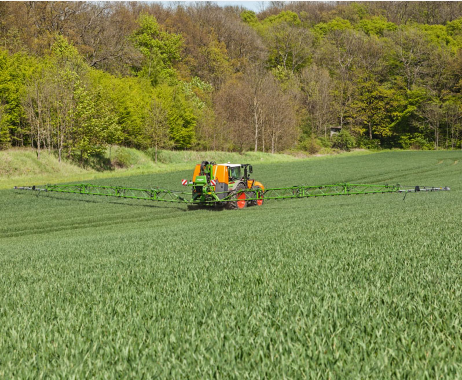
Anbaufeldspritze UF 2002 mit ContourControl zur vollautomatischen Gestängeführung
