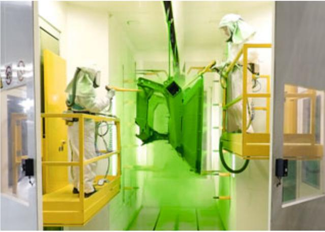
Der doppelte Schutz, durch die zusätzliche dick aufgebrachte Pulverbeschichtung, verbessert den Schutz vor mechanischer Beanspruchung
