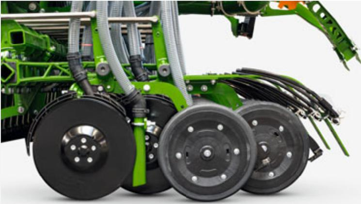
Das zweite Fördergut wird über eine separate Förderstrecke zum zusätzlichen Auslauf am TwinTeC-Schar geleitet und vor der Tiefenführungsrolle platziert
