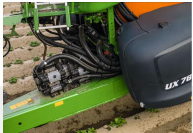
Neue entwickelte Kolbenmembranpumpen mit hydraulischem Antrieb
