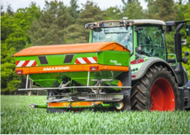
Das optionale Grenzstreusystem Limiter V<sup>+</sup> ist in das Bedienkonzept des AmaSpread 2 integriert
