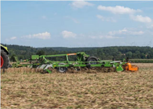
Cobra-2TX mit vorlaufender Messerwalze in der Rapsstoppelbearbeitung
