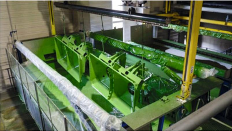
Die KTL-Tauchgrundierung aller Komponenten ermöglicht einen nahezu flächendeckenden Korrosionsschutz. Das Hinterwandern der Lackierung durch Rost soll dadurch so effektiv wie möglich verhindert werden.
