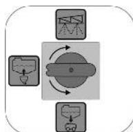
5. Desconectar el accionamiento de la bomba de pulverización, si después de conmutar varias veces entre las posición de la válvula de aspiración y grifería de presión ya no sale líquido de los conductos de las toberas.
