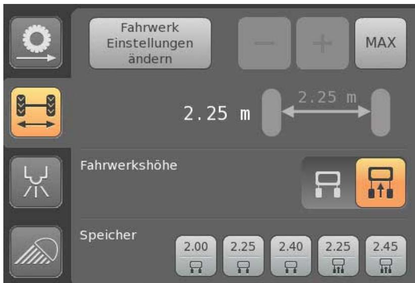
**i** El ajuste de la altura se realiza junto con el ajuste del ancho de vía durante un recorrido breve de ajuste.
