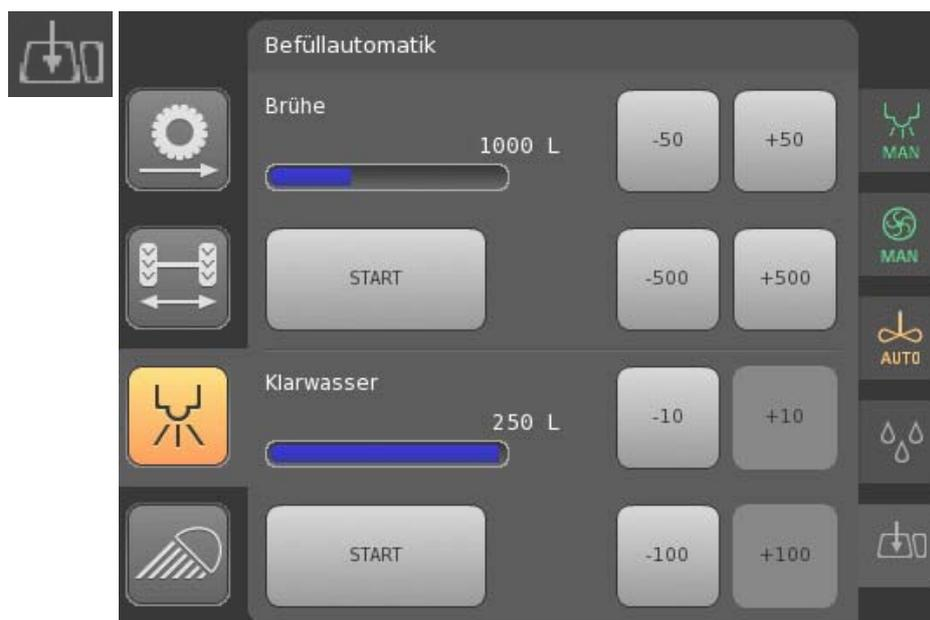
El depósito de líquido de pulverización y el depósito de agua de enjuague pueden llenarse simultáneamente o por separado a través de la manguera de aspiración.
