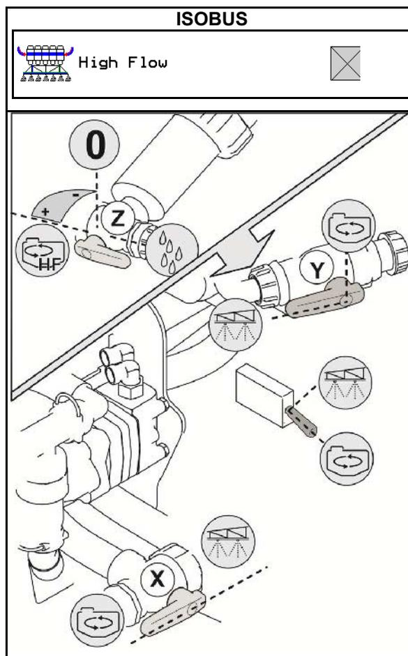
6. Si fuera preciso, seleccionar los dos conductos de rociado en la llave de conmutación del conducto de rociado.
