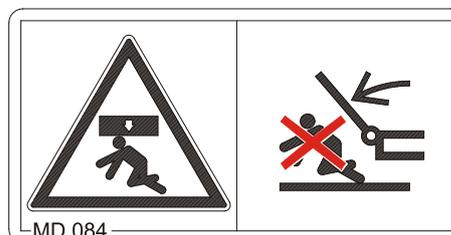
**MD 086****Risques d'écrasement de l'ensemble du corps en cas de séjour sous des éléments de la machine relevés et non sécurisés !**
