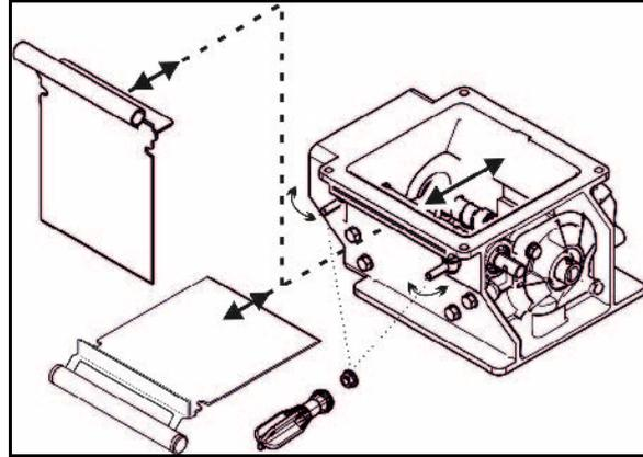
3. Injektorschleusenklappe öffnen, damit das Saatgut / der Dünger in die Abdrehwanne fließen kann.
