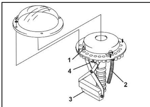
Die Saatgutzufuhr zu den Fahrgassenscharen wird unterbrochen, sobald der Elektromotor (3) die entsprechenden Saatleitungsrohre (2) im Verteilerkopf verschließt.
