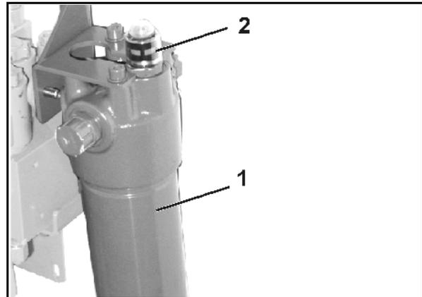
Ölfiler Bordhydraulik mit Verschmutzungsanzeige:
