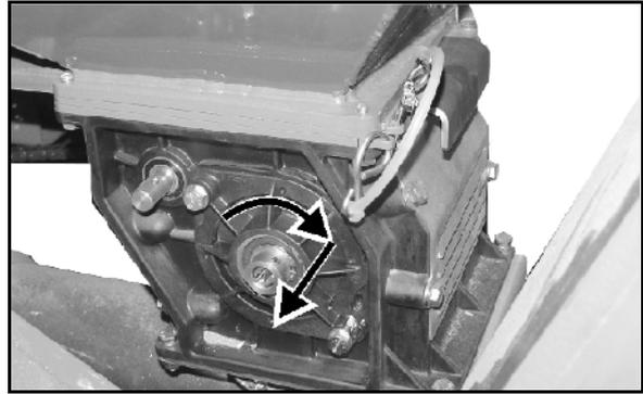
5. Die Dosierwalze aus dem Dosierer herausziehen.
