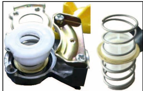
**!** O-Ring korrekt auf dem Kunststoffring positionieren.
