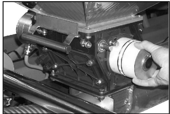
6. Gegebenenfalls Schieber wieder aus dem Schlitz im Dosierer ziehen und in Parkposition befestigen.
