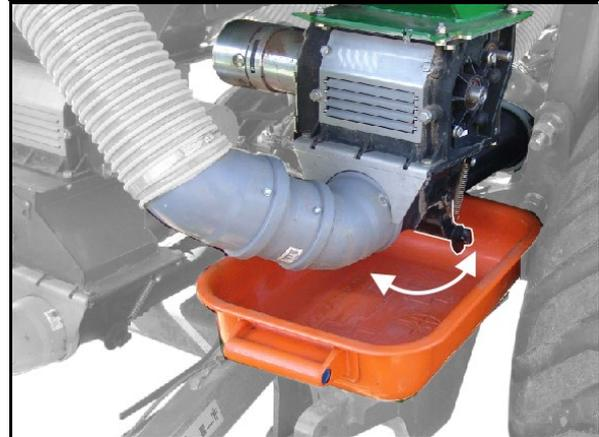
4. Den Kalibriervorgang anhand der Software-Betriebsanleitung so oft durchführen, bis die gewünschte Menge ausgebracht wird.
