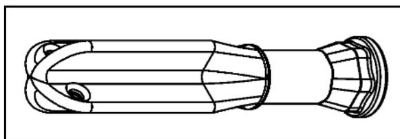
2. Die Behälteröffnung mit Schieber verschließen (nur bei gefülltem Behälter erforderlich).
