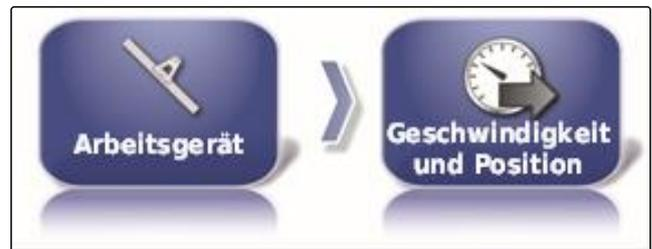
Wenn die ISO-Fahrgeschwindigkeit aktiviert ist, wird die Geschwindigkeit über das ISOBUS-Protokoll an das Arbeitsgerät übermittelt.
