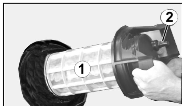
Druckfilter bei befülltem Behälter reinigen
