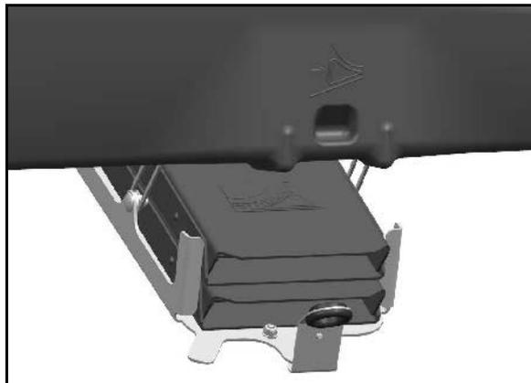
Die klappbaren Unterlegkeile durch Betätigen des Druckknopfes in Einsatzstellung bringen und vor dem Abkuppeln direkt an die Räder anlegen.
