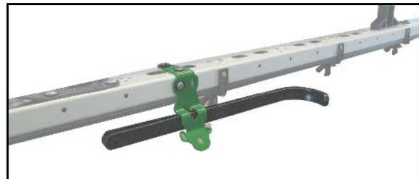
**Transportverriegelung ent- und verriegeln**
