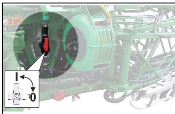
2. Druckarmatur **DA** Flüssigkeitsverlauf sperren.
