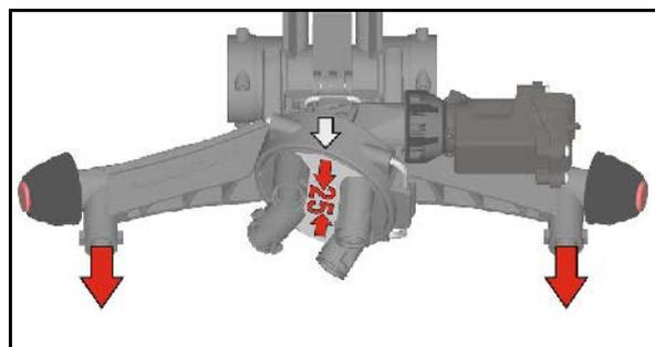
25 cm Düsenaufnahme montieren.
