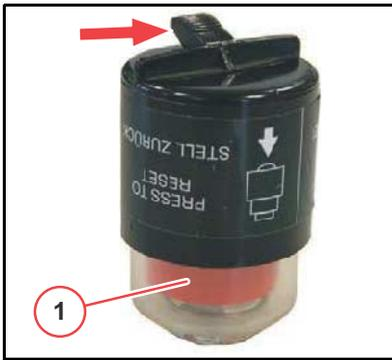
Wartungsanzeiger für Trockenluftfilter
