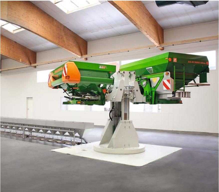
Dafür wurden im Zuge eines Komplettumbaus im Inneren der bisherigen Testhalle eine neu konzipierte Testvorrichtung samt innovativer Mess- und Auswertungstechnologien installiert, was zu einer Vielzahl von entscheidenden Verbesserungen führt. So lassen sich jetzt z.B. Düngestreuer bis zu einer Arbeitsbreite von 72 m
