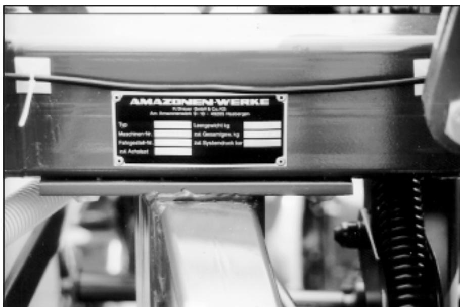
Veillez reporter à cet emplacement le numéro de série de votre machine. Le numéro de série de la machine est indiqué sur la plaque du constructeur fixée sur le côté gauche du châssis, vu dans le sens de l'avancement.
