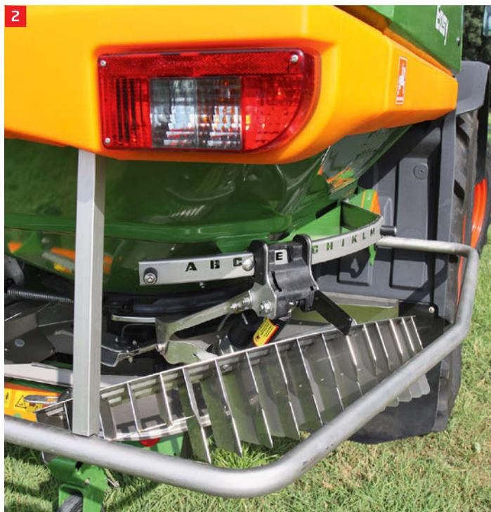
**1** Der Limitier V+ besteht aus unterschiedlich geformten Lamellen, deren Wirkung sich über die Absenktiefe dosieren lässt.
