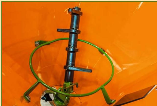
*Entraînement hydraulique des disques d'épandage avec agitateur en polyéthylène pour un épandage précis*
