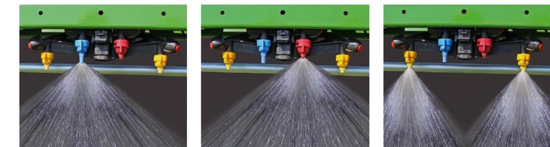
Elektrische Einzeldüsenschialtung AmaSelect mit 4-fach-Düsenkörper und 50 cm bzw. 25 cm Düsenabstand
