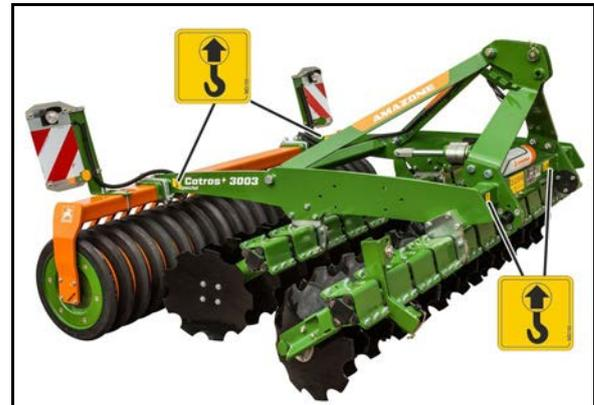
La machine dispose de 4 points d'amarrage pour les sangles de levage.
