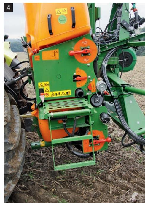
Das Mittelstück bekam einen neuen Pendelausgleich mit der bewährten 3-Fach-Dämpfung. Zum einen wird das Gestänge vertikal mittels Zugfedern gedämpft, die im Hubmast verbaut sind. Zum anderen werden die horizontalen Schwingungen durch zwei Gummidämpfer am Bolzen des Zentralpendels mit Kugelgelenk absorbiert.
