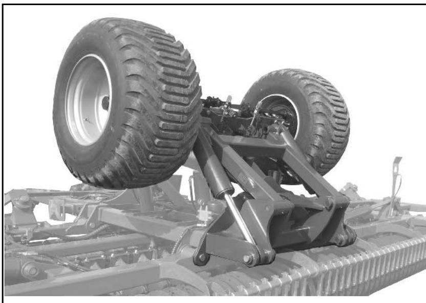
**Ходовая часть при транспортировке:**
