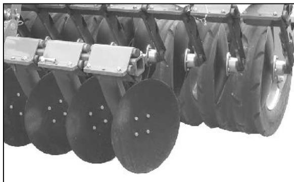
Для замены дисков ослабьте четыре резьбовых соединения и затем снова затяните.
