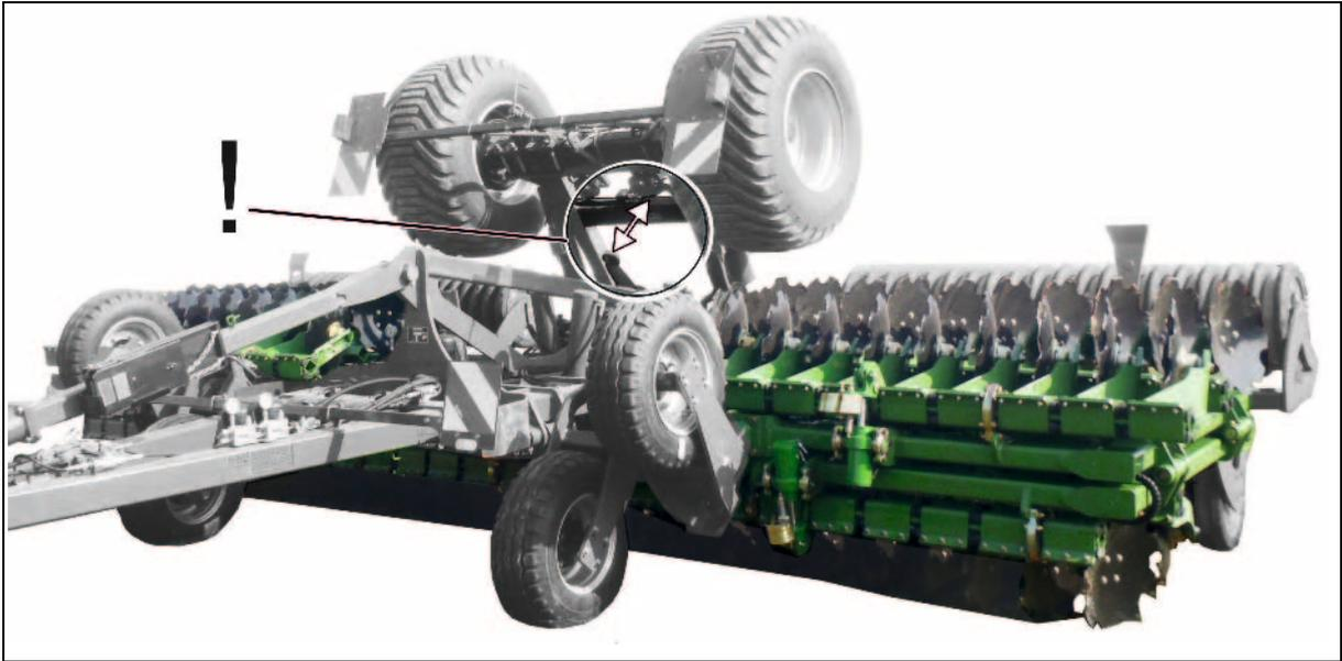
При работе с укороченной шириной захвата наружные консоли остаются сложенными.
