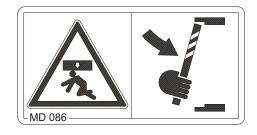
Risques d'écrasement de l'ensemble du corps en cas de séjour sous des charges en suspens ou des éléments de la machine relevés et non sécurisés!
