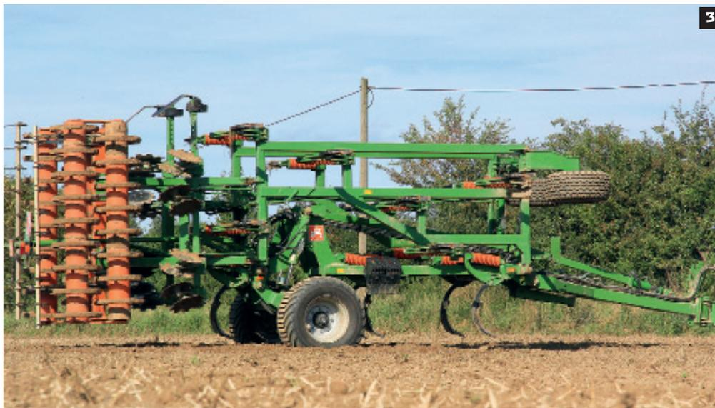
offenen Bauweise vor allem für leichte und mittelschwere Standorte gedacht. Die Bauart wird dort bereits von anderen Herstellern seit Jahren erfolgreich verwendet.
