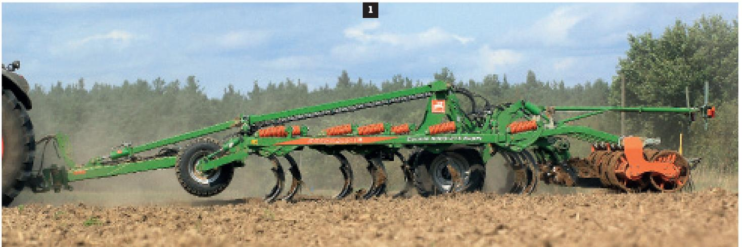
**1** Der Cenius TX Super ist vierbalkig aufgebaut, wobei der zweite und dritte Balken aufgelöst angeordnet sind. Optional ist die Zwischenfruchtdrille GreenDrill mit 500 l-Tank erhältlich.
