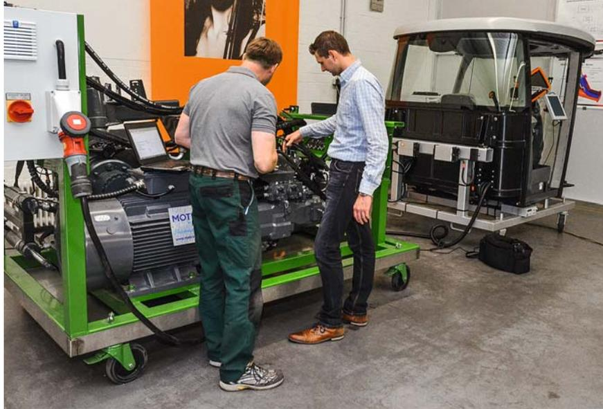
In dem für den Pantera eingerichteten Trainingsbereich ist nicht nur Platz für das komplette Fahrzeug, sondern zusätzlich auch für ein 1:1-Modell des kompletten Antriebsstranges sowie eine voll funktionsfähige Fahrerkabine.
